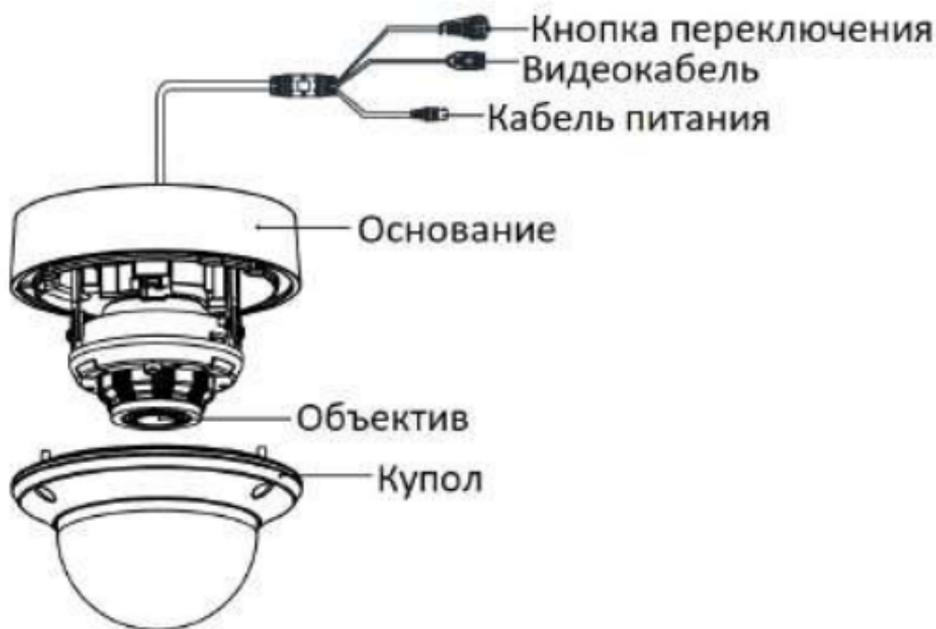
Рисунок 1-2 Камера II типа
